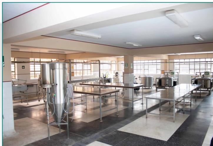
El taller dispone de zonas de recepción, lavado, reducción de tamaño, pulseado, pasteurizado y envasado. Cada una de ellas dispone del equipamiento para las distintas operaciones propias del proceso productivo, un aspecto que se debe tener presente es el de los detalles de construcción, altamente determinantes de la calidad de una planta física para cumplir con los objetivos de adecuarse a una producción de alimentos.
